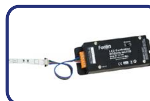
Шаг 4. Подключить соединитель к драйверу при помощи клемм или специальных разъемов в зависимости от вида соединителя.
